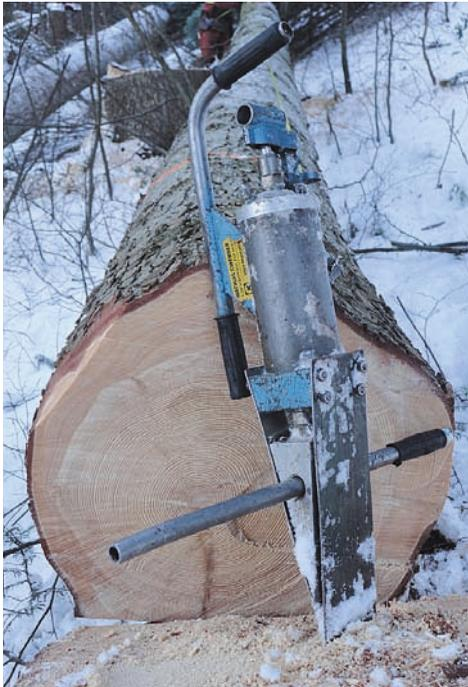
**Mit der Pumpstange kann der Keil nach der Verwendung in die Ausgangsposition zurückgezogen werden. Foto: Christoph Ammann**
