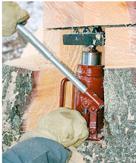
**Für den Einsatz des hydraulischen Fällhebers muss eine Öffnung ausgesägt werden.**
