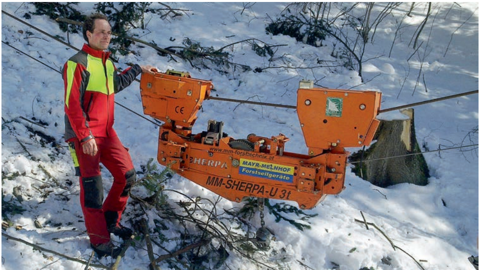
Der Laufwagen, erklärte Betriebsleiter Benjamin Bachmann, erreicht ohne Last die beeindruckende Geschwindigkeit von knapp 10 m/s und mit Last noch über 5 m/s. Foto: Walter Bachmann
