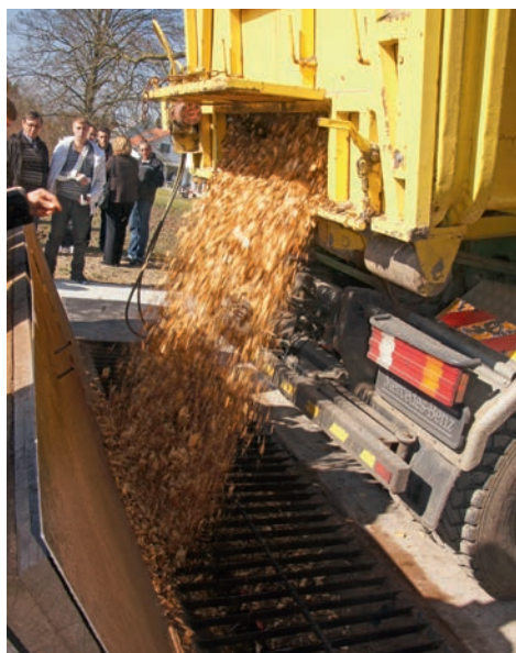
Mittels einer Transportschnecke werden die Hackschnitzel vom Transporter in den Silo befördert.
