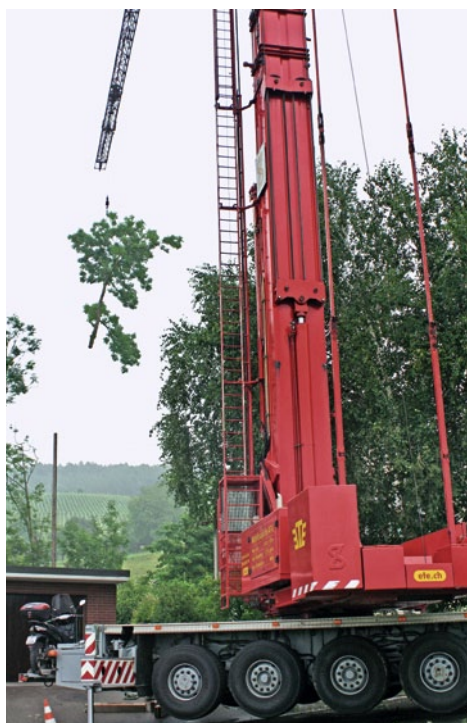
Mangels direkten Zugangs musste ein Autokran die Bäume stückweise über die Häuser hieven. Foto: Claudia Meile
