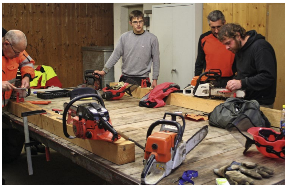
Der einfache Unterhalt der Motorsäge, insbesondere das fachgerechte Schärfen der Kette, ist Voraussetzung für das reibungslose Funktionieren der Säge und daher Bestandteil der Ausbildung. Foto: Claudia Meile
