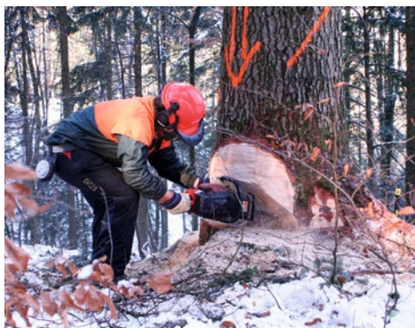
Bei sehr dicken Bäumen ist der Herzschnitt von der Fallkerbenseite her anzuwenden, damit auch in der Baummitte alle nötigen Holzfasern durchtrennt werden können. Foto: Claudia Meile
