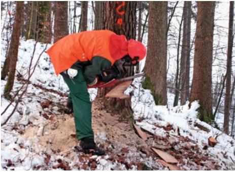
Damit das Schwert aufgrund der nach vorne hängenden Krone nicht eingeklemmt werden kann, wird die tiefe Fallkerbe immer scheibenweise herausgesägt. Foto: Claudia Meile
