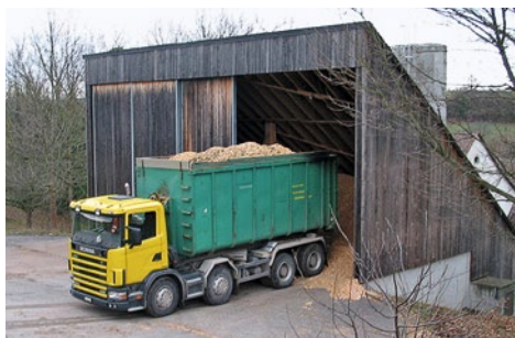
Anlieferung der Holzschnitzel im 40-Kubikmeter-Container mit dem LKW und Lagerung im Vorsilo. Foto: Hans Weber
