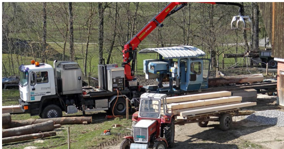
Mobile Blockbandsägen verfügen über die gleichen technischen Komponenten und Fähigkeiten wie eine stationäre Variante, sind aber so konstruiert, dass sie leicht transportierbar sind und verhältnismässig wenig Platz beanspruchen. Foto: Claudia Meile
