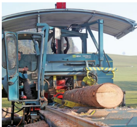
Der Stamm wird mit Wendeketten positioniert und dann fixiert. Anschliessend fahren die Sägerkabine und der Sägekopf über den fixierten Stamm hinweg. Foto: Claudia Meile
