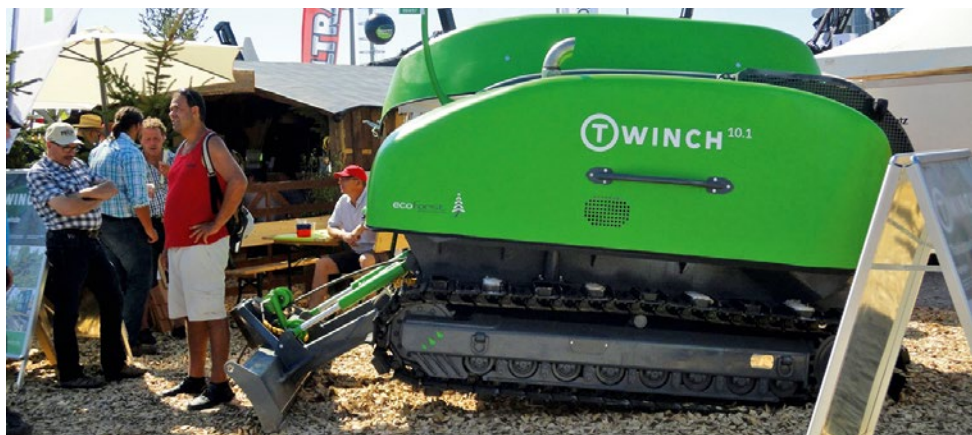
Eine selbstfahrende Traktionswinde – demnächst im Thurgauer Wald im Einsatz. Foto: Werner Gerber
