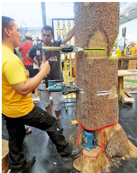
Eine Weiterentwicklung des hydraulischen Fällkeils – Keilvortrieb mittels Rätzsche. Foto: Werner Gerber
