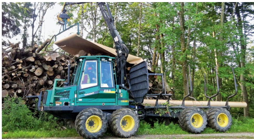
Mit dem Forwarder wird ein Energieholzhaufen mit regendichtem Papier abgedeckt. Foto: Beat Wydenkeller
