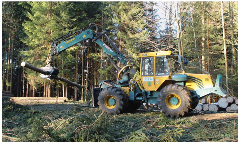
Mit dem Zangenschlepper werden nach dem Rücken aus dem Bestand auf dem Aufarbeitungsplatz die einzelnen Sortimente zu Poltern gelagert. Foto: Roger Hollenstein
