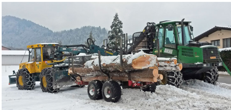
Forwarder und Zangenschlepper, hier beide wintertauglich ausgerüstet, werden auch bei Aufträgen für Dritte eingesetzt. Foto: Roger Hollenstein
